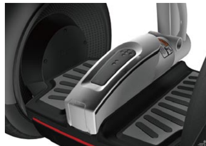
「走るノートパソコン」と言われるほど、精密なテクノロジーが駆使された本体部分。7つのセンサーで重心移動をコントロールし、乗車中のバランスを保つ。
